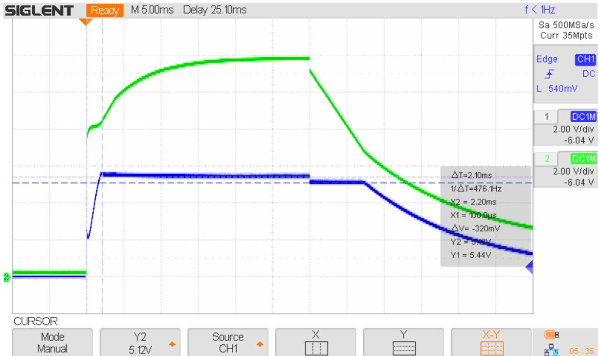
**Figura 8:** Risposta di  $V_{out}$  con carico di 10ohm, controllo con PMOS – scheda con L7805 ( $V_{in}=12V$   $V_{out}=5V$ ).
